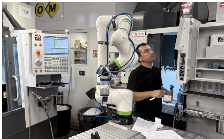
Parmi les investissements récents, le bras robotisé qui permet d'usiner même le week-end. PHOTO M.-C. B.
